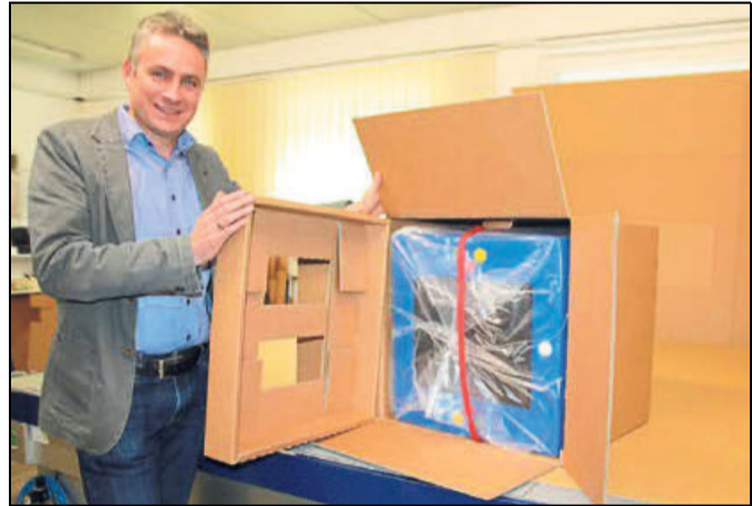
Wo früher oft Styropor zum Auspolstern genutzt wurde, kommen nun Wellpappenpolster zum Einsatz. Geschäftsführer Daniel Laufer demonstriert, wie das geht.
